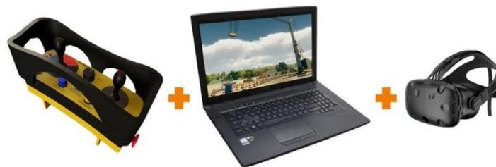
Grâce à ce nouveau dispositif, l'apprenant peut **piloter l'engin et se confronter aux risques** de sa manipulation **en toute sécurité**. Un seul geste de la main suffit pour déambuler librement sur le chantier. A lui d'exécuter ensuite les exercices depuis un **boîtier de commande interconnecté avec le dispositif VR**. Un équipement léger donc, qui présente de nombreux avantages au regard d'une formation sur engin réel :
